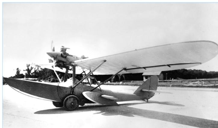
В 1932-1934 гг. таганрогские авиастроители во главе с новым Главным конструктором завода В.Б. Шавровым быстро осваивают и запускают в серийное производство первый отечественный гидросамолет-амфибию Ш-2. Этот небольшой деревянный полотораплан оказался очень технологичным и имел прекрасные для своего
