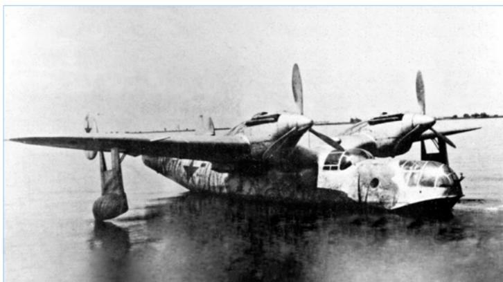
С 1939 г. в ОКБ Г.М. Бериева началась работа над корабельным катапультным разведчиком КОР-2, предназначенным для вооружения кораблей создававшегося «Большого океанского флота». Эта машина впервые взлетела в октябре 1940 г. Учтя опыт создания и длительной доводки КОР-1, конструкторы создали неплохой самолет, который был запущен в серийное производство.
