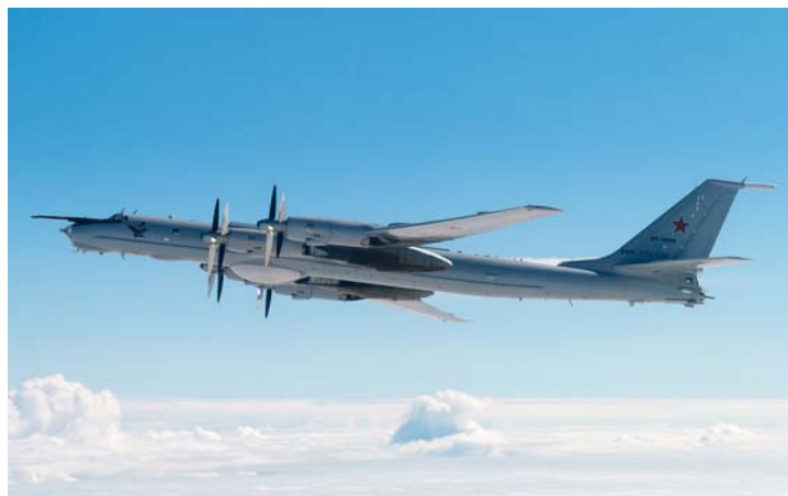
Дальний противолодочный самолет Ту-142МЗ ВМФ России (бортовой номер: RF-34098/64). 2020 г. Обратите внимание на обтекатель поискового комплекса в носовой части фюзеляжа.
