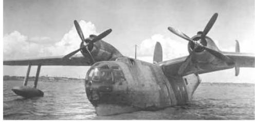
По общей компоновке самолет, повторяя МДР-10, имел цельнометаллическую конструкцию с полотняной обшивкой рулей и элеронов. В качестве силовой установки ЛЛ-143 выбрали две двухрядные «звезды» воздушного охлаждения АШ-72, разработанные ОКБ А.Д. Швецова, с номинальной мощностью 2000 л.с. (взлетная мощность - 2250 л.с.).
