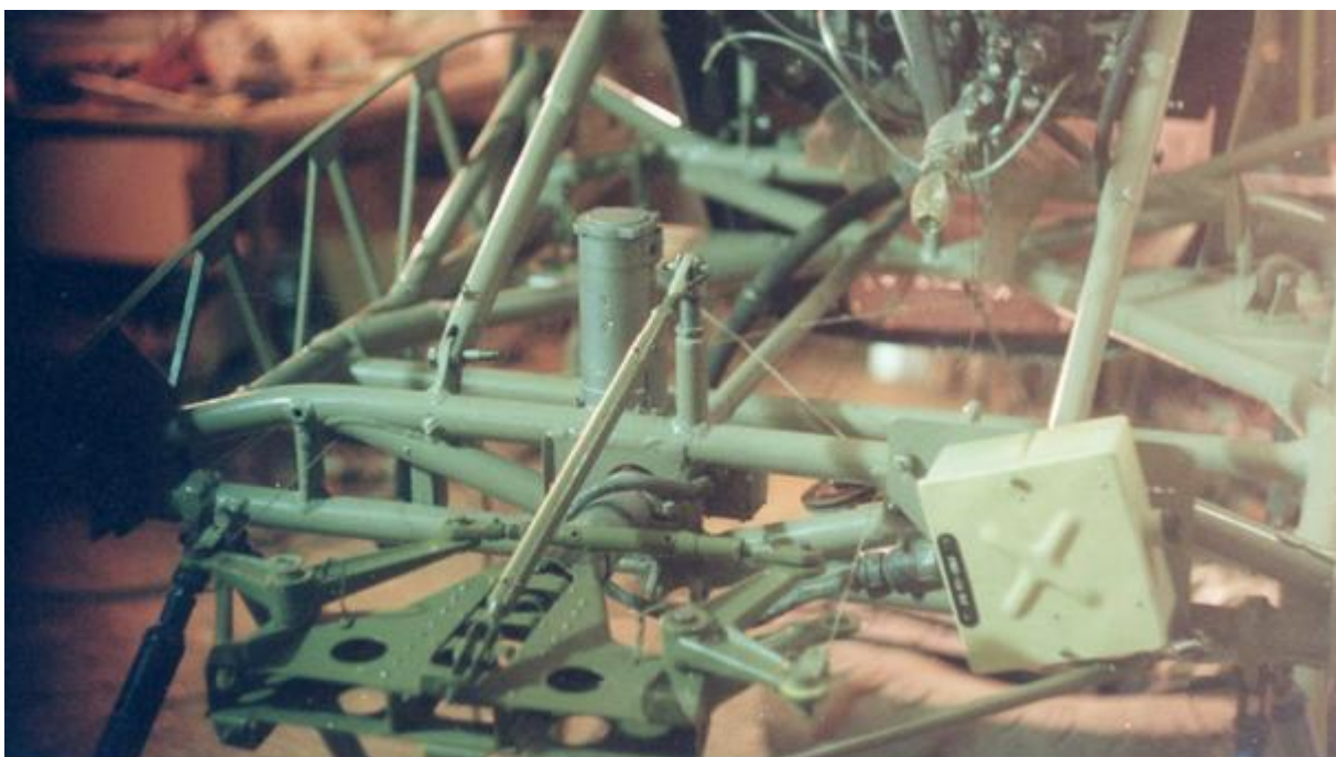
Рис. 21. Механизм уборки-выпуска закрылков УЗ-1АМ.
