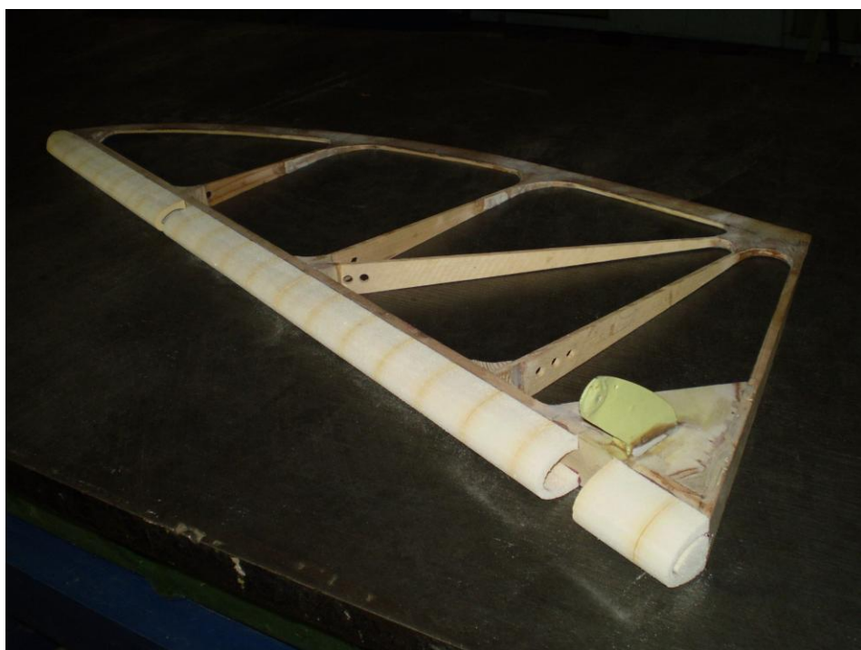
Рис. 17. Каркас правой половины руля высоты.
