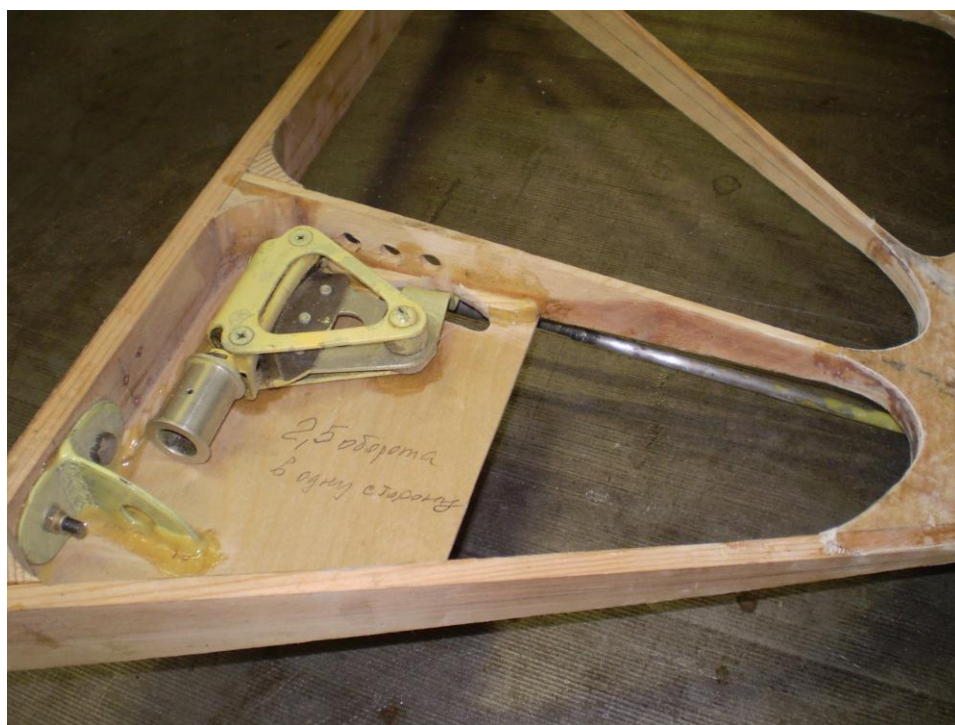
Рис. 30. Механизм привода триммера РВ.
