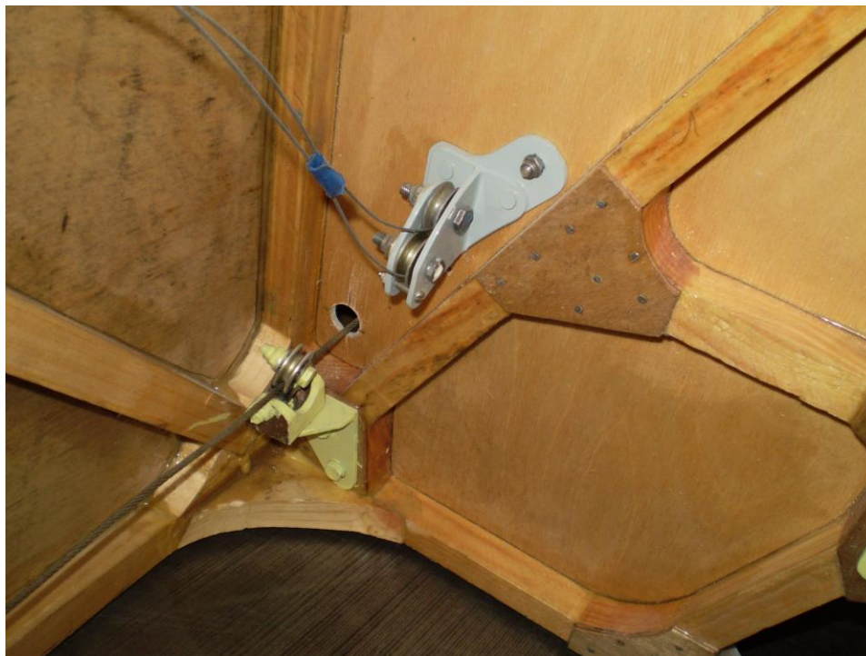
Рис. 29. Ролик троса РН и ролики триммера РВ.
