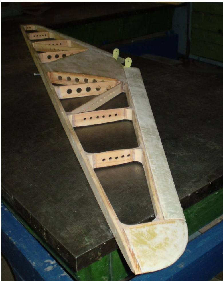
Рис. 16. Каркас стабилизатора ( перевернут ).
