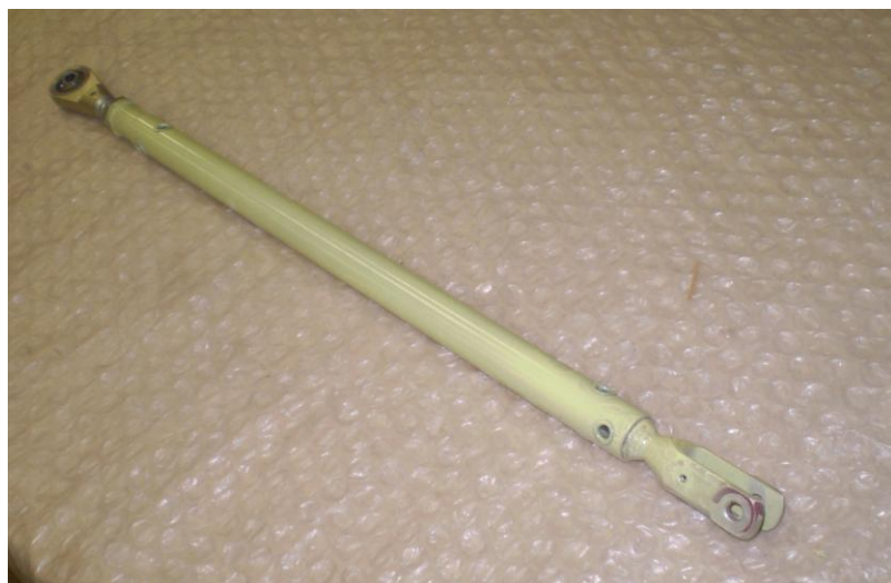
Рис. 32. Типовая тяга жесткого управления.
