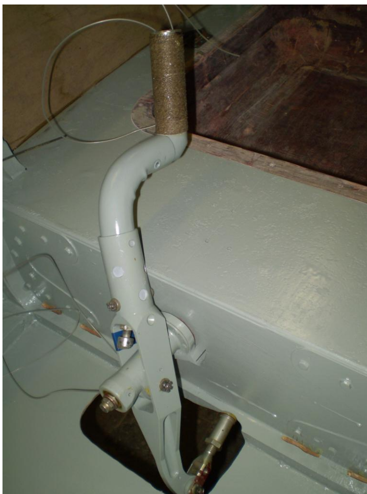
Рис. 23. Ручка управления самолетом (РУС).
