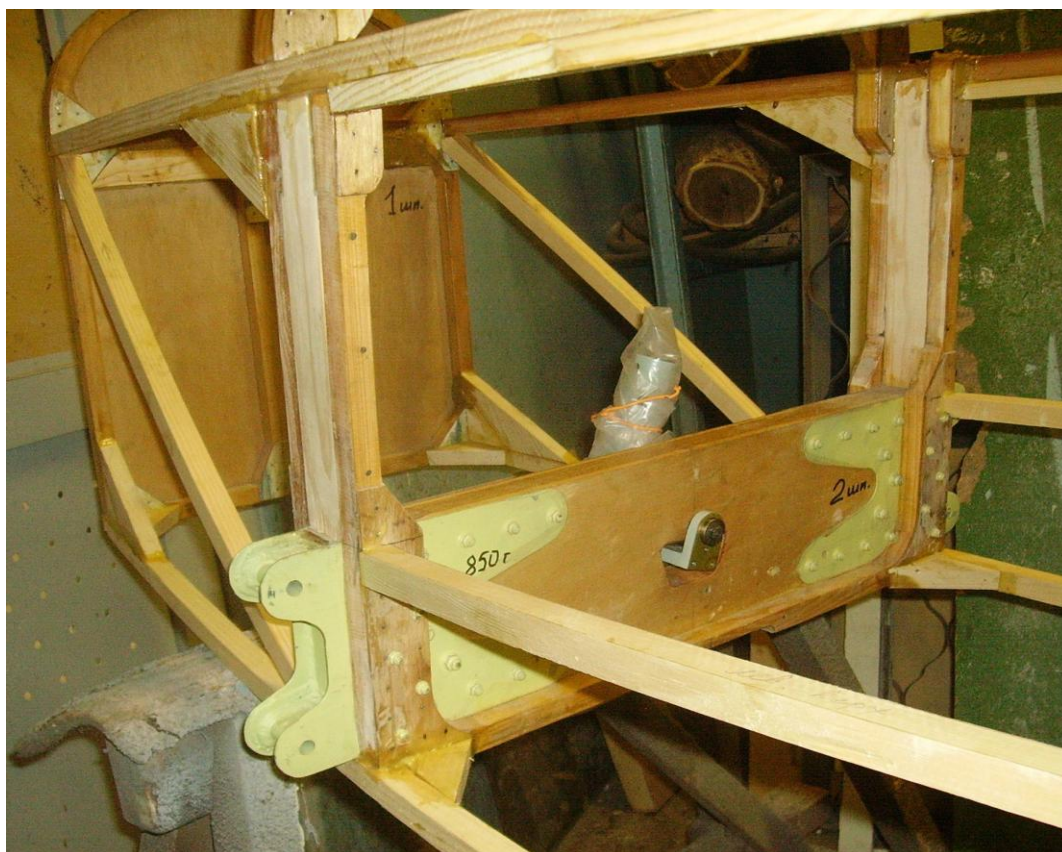
Рис. 15. Центроплан основного (переднего) лонжерона.
