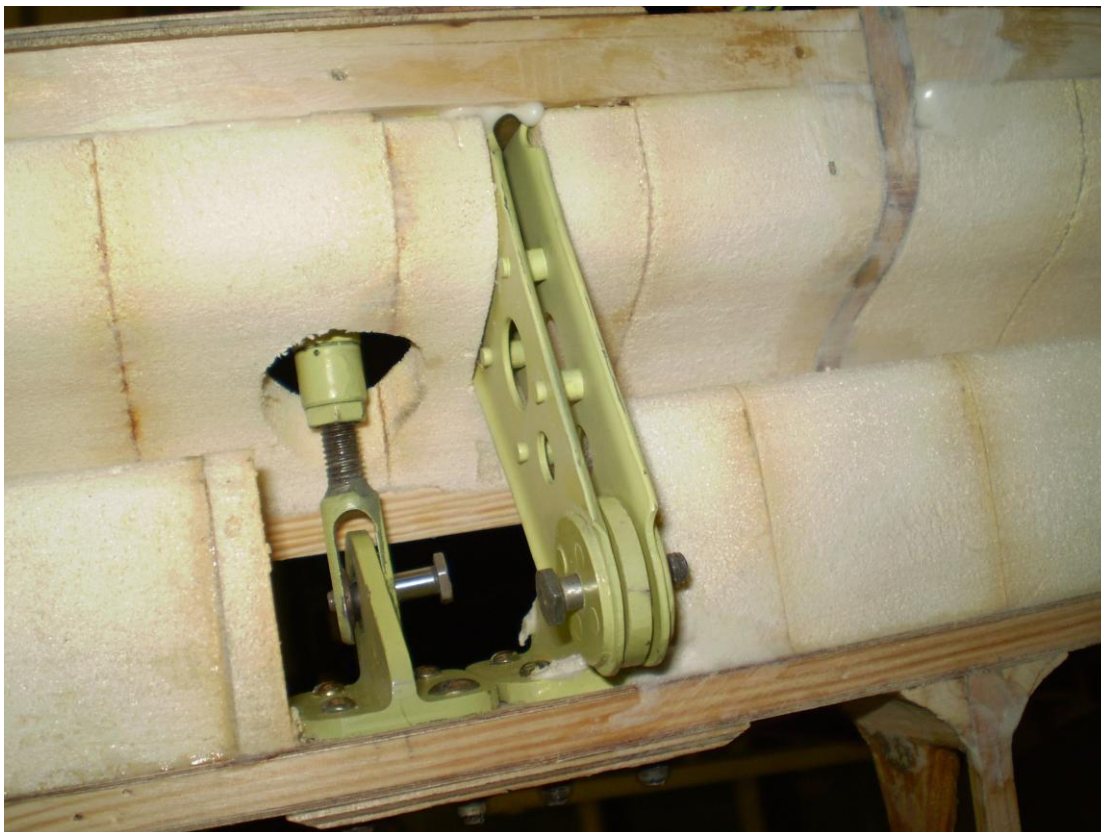
Рис. 13. Узел крепления элерона и качалка с тягой.
