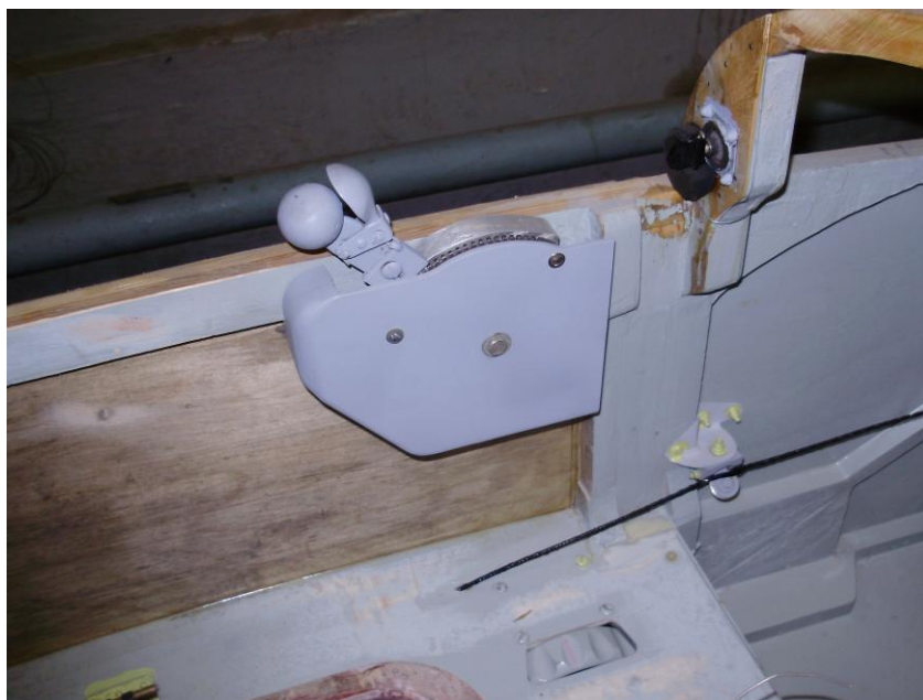
Рис. 35. Рычаг управления двигателем (РУД).
