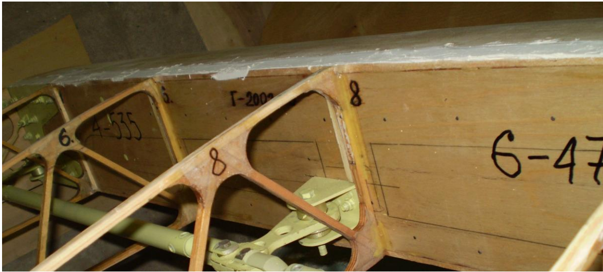
Рис. 11. Основной (передний) лонжерон.
