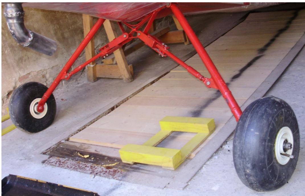
Рис. 20. Основные стойки шасси.
