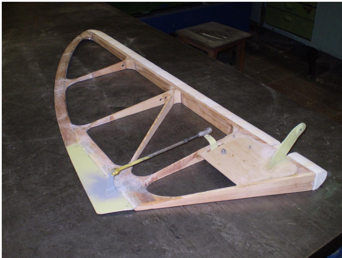
Рис. 17. Каркас левой половины руля высоты.
