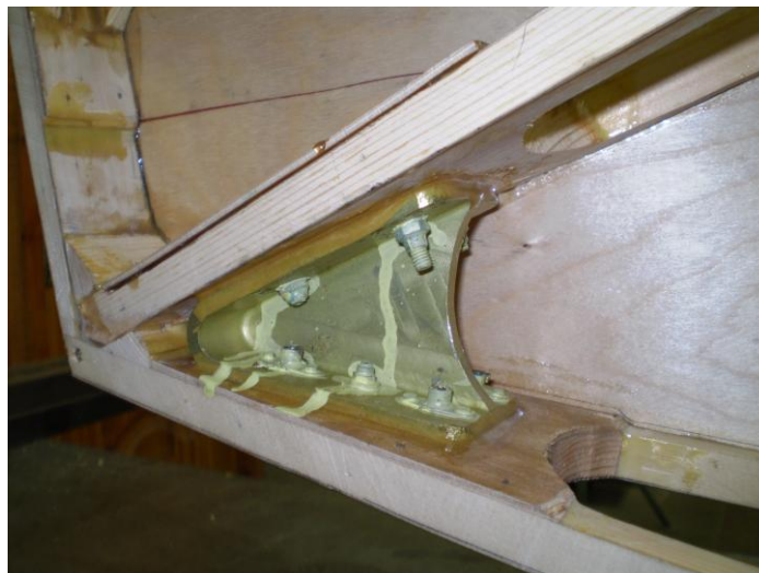
Рис. 22. Узел крепления костыля.
