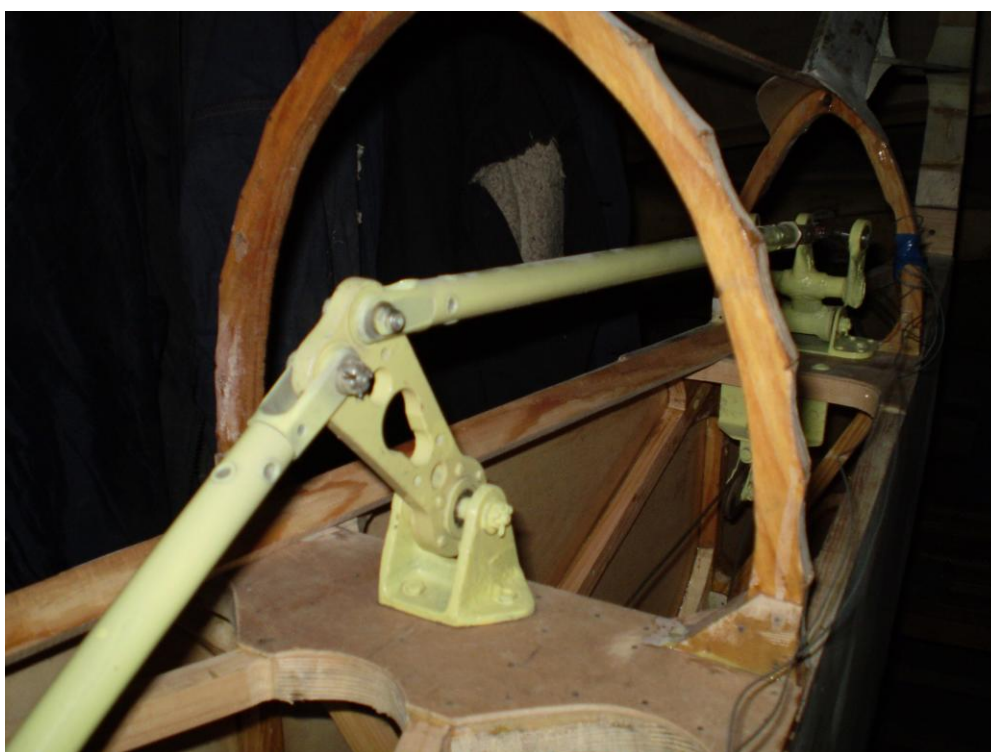
Рис. 25. Качалка РВ на верхней части фюзеляжа.
