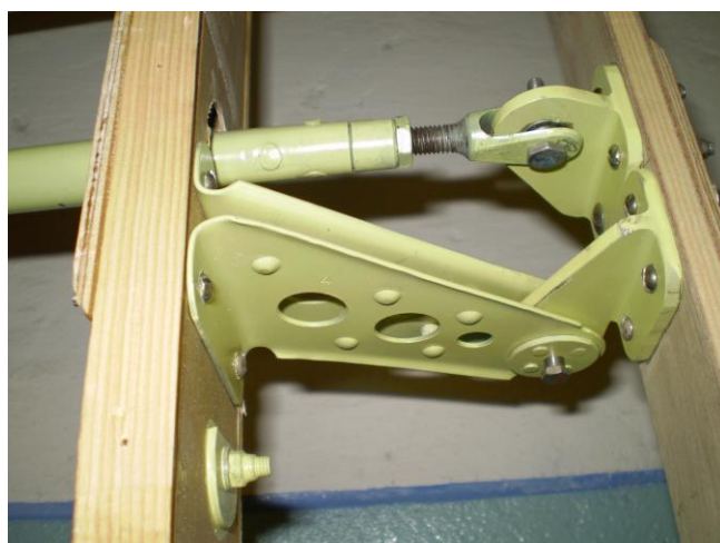
Рис. 32. Типовая тяга жесткого управления.
