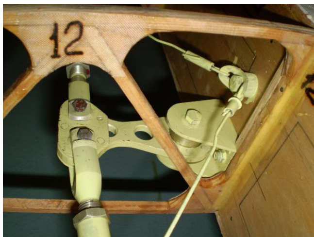
Рис. 33. Качалка в крыле.
